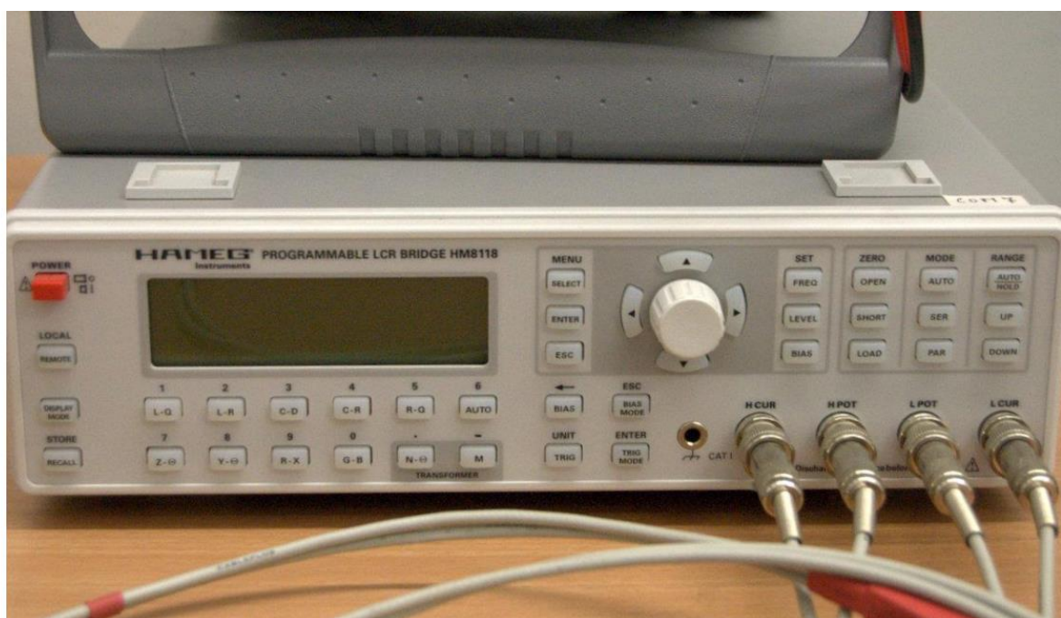
Měřicí RLC můstek Hameg LCR HM 8118
